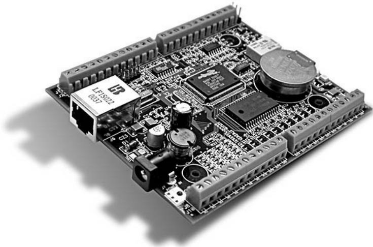
La carte BL2000 est idéale pour le contrôle embarqué et les applications de surveillance. Sa taille réduite (87 x 105 x 21 mm) permet une intégration aisée dans les endroits les plus exigus.
